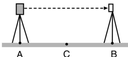
2. Mida 10 veces, con precisión, la distancia horizontal entre el punto A y el punto B. Calcule la distancia media.
